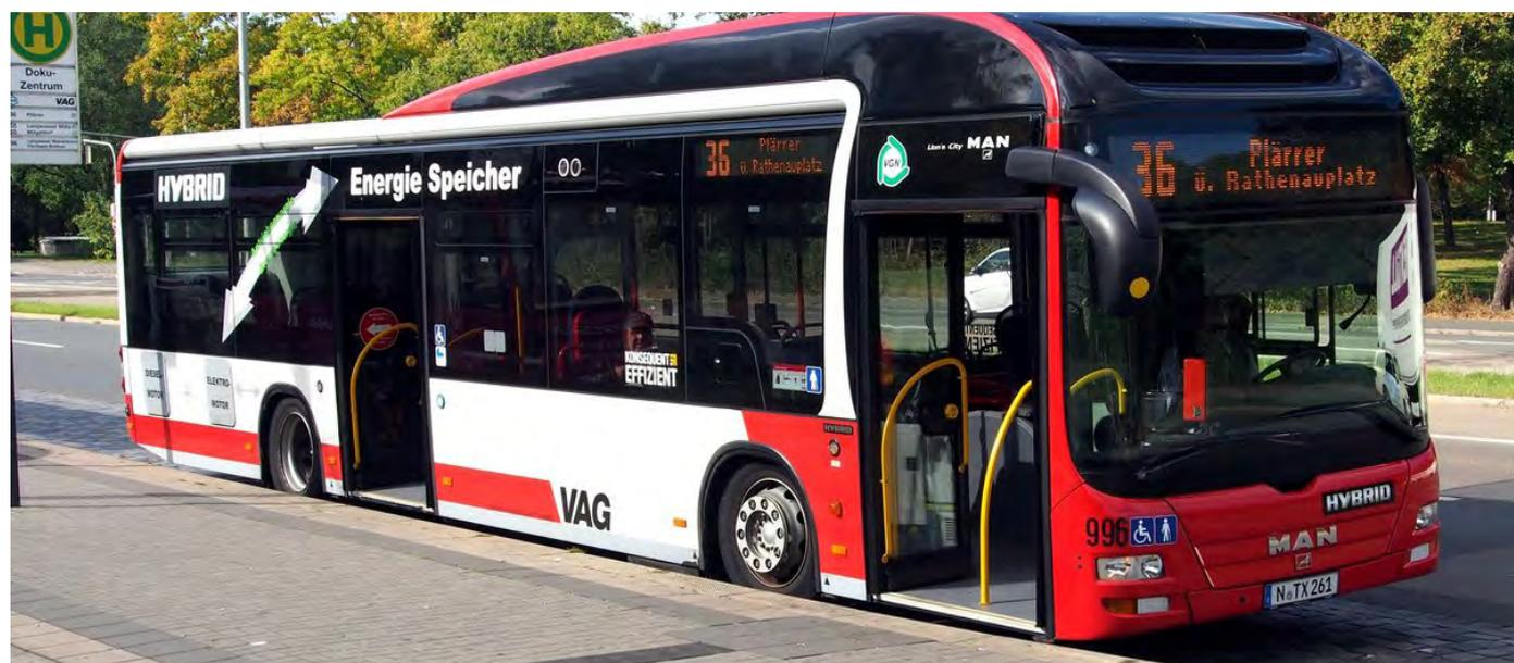
С начала этого года городская транспортная компания VAG в Нюрнберге эксплуатирует самый первый сочлененный электрический автобус с системой термического управления CO<sub>2</sub>-тепловым насосом Konvekta.
